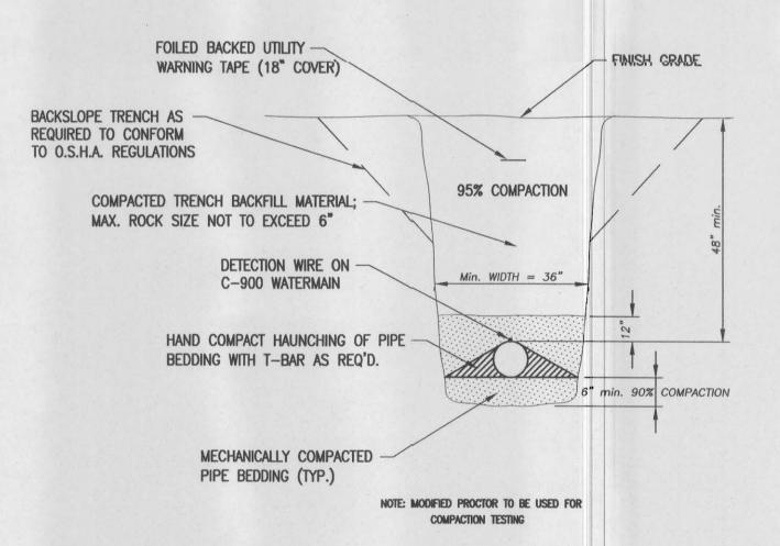
TRENCH EXCAVATION & BACKFILL DETAIL
